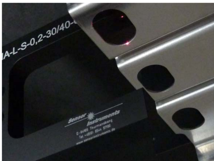
Precyzyjne pozycjonowanie wyłaczanej części za pomocą widelkowej zapory świetlnej FIA-L-RL
